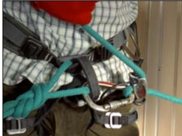
Bild 32:C 2 Undvik tvårdrag = mindre belastning i säkraren!
