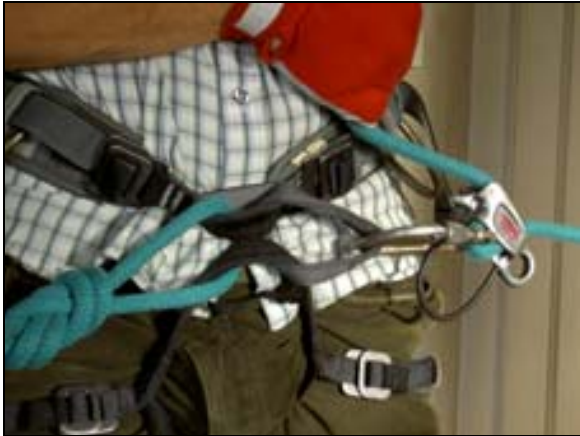
Bild 32:C 1 Tvårdrag = belastning i säkraren!
